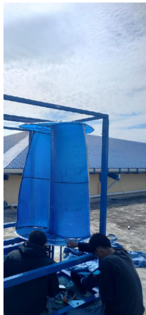
Gambar 1. Prototipe VAWT Savonius Helical-Bach modifikasi yang digunakan pada pengujian rooftop
