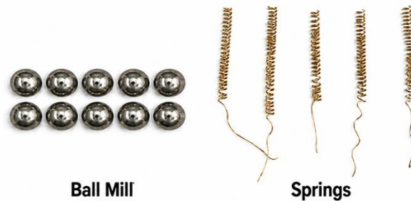
Gambar 1. Media pencampuran Ball Mill dan Springs
