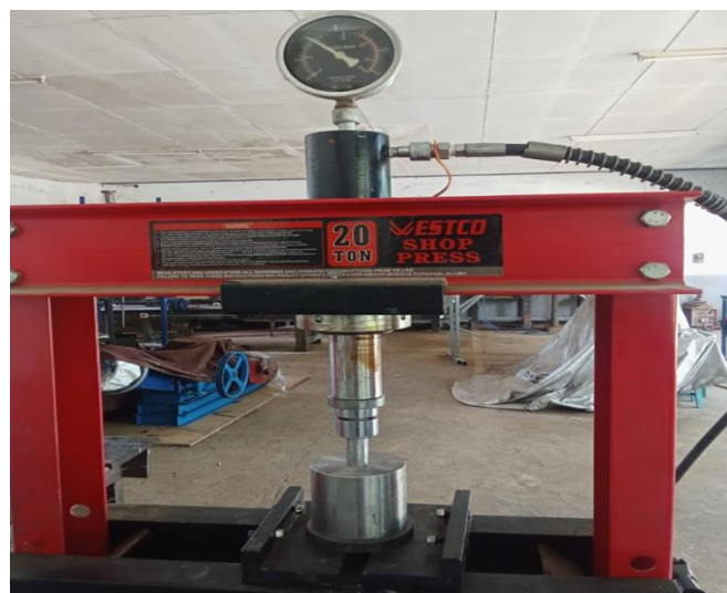
Gambar 3. Mesin Press merk Vesto kapasitas 20 Ton
