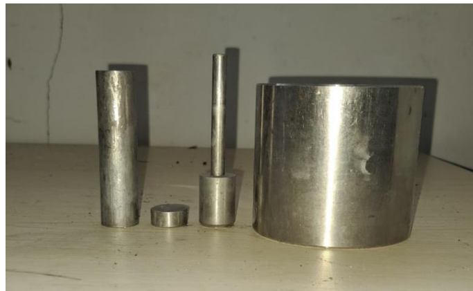
Gambar 2. Cetakan untuk pembuatan Bushing
